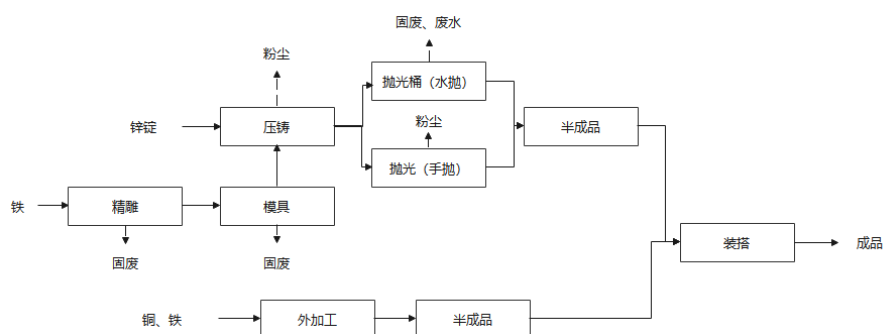
图 2-3 扩建后项目运营期生产工艺流程及产污环节图
